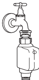
ασφαλής σωλήνας τροφοδοσίας
